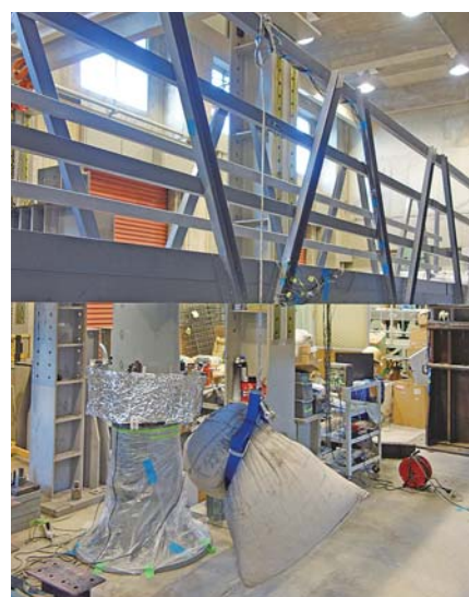
【写真2】手摺への衝撃載荷試験
